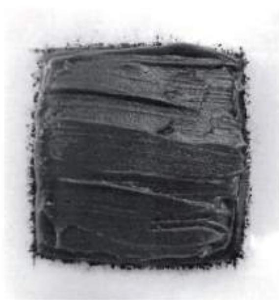
Foto 1: Untersuchungsmaterial MEZ-BLUEMASTIC-GEL, Farbe blau nach einer Inkubationszeit von 28 Tagen ohne sichtbaren Pilzbewuchs
