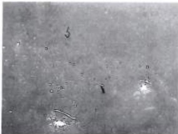
Foto 2: Untersuchungsmaterial MEZ-BLUEMASTIC-GEL, Farbe blau nach einer Inkubationszeit von 28 Tagen mit leichtem Pilzwachstum (50fach vergrößert)
